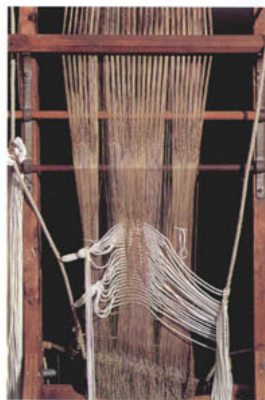
In alto: una risiblatrice utilizzata per il controllo e la pulitura dei tessuti dopo la tessitura. Sopra: lisage a corde per la lettura dei disegni delle macchine jacquard. Gran parte degli strumenti e degli attrezzi conservati nel museo offrono una testimonianza della tecnologia legata alla seta, ma soprattutto parlano dell'indissolubile legame tra loro e gli uomini che le hanno realizzate. Pagina a fianco: un'altra immagine tratta dall'archivio di Pepi Merisio sul lavoro delle filande.
