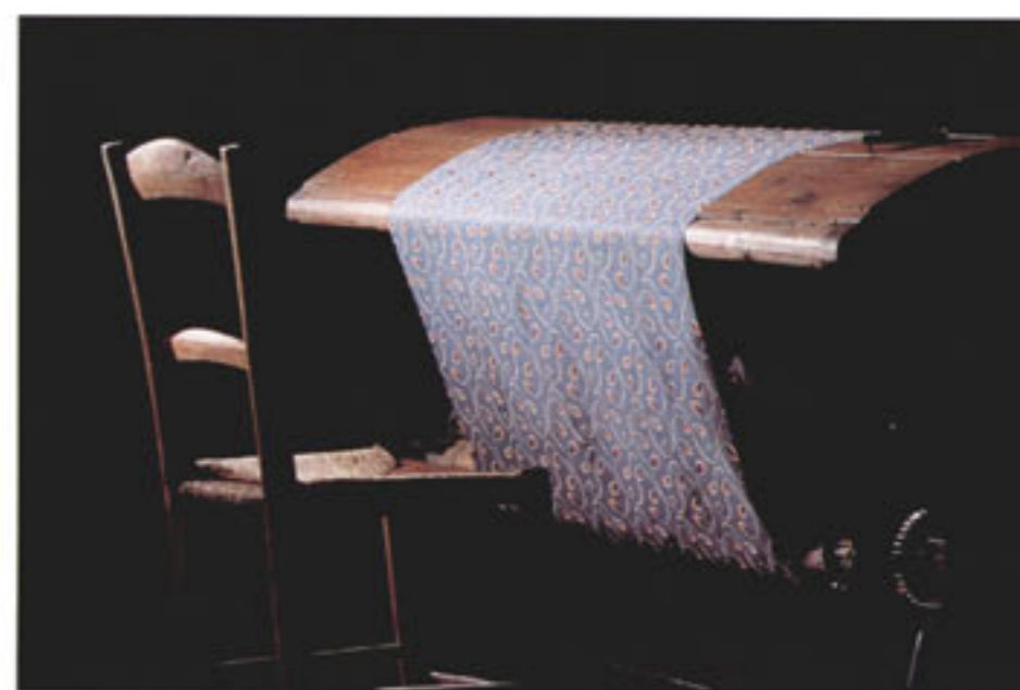
In alto: una risiblatrice utilizzata per il controllo e la pulitura dei tessuti dopo la tessitura. Sopra: lisage a corde per la lettura dei disegni delle macchine jacquard. Gran parte degli strumenti e degli attrezzi conservati nel museo offrono una testimonianza della tecnologia legata alla seta, ma soprattutto parlano dell'indissolubile legame tra loro e gli uomini che le hanno realizzate. Pagina a fianco: un'altra immagine tratta dall'archivio di Pepi Merisio sul lavoro delle filande.
